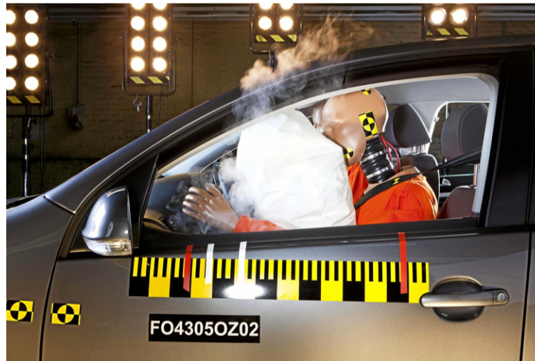
Der klassische Test-Crash: Die verwendete Dummyspuppe ist einem Mann nachempfunden.
